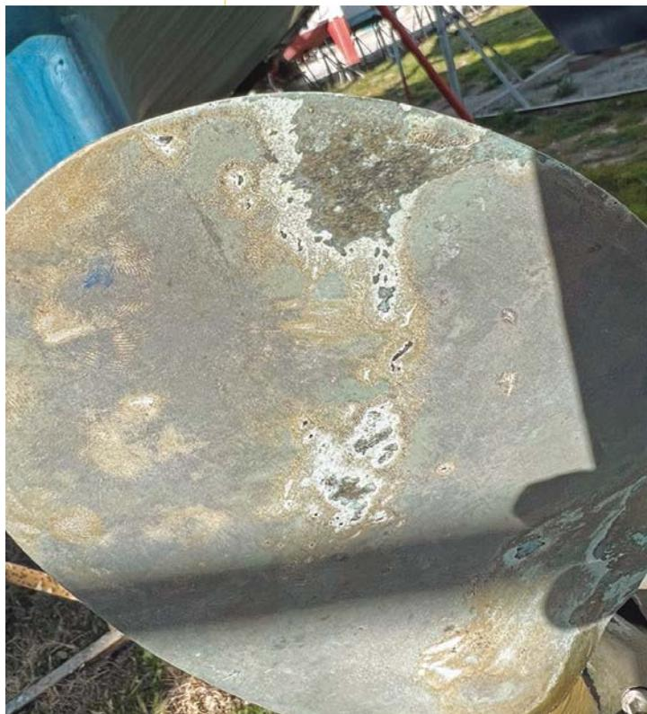
El ánodo de esta hélice ha hecho su trabajo y necesita ser reemplazado antes de que pueda causar daños a las palas.
