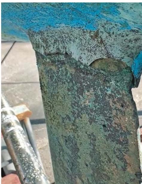
El juego del cojinete ha permitido al eje oscilar y las vibraciones han comprometido la estructura de fijación del arbotante. La reparación de la estructura es urgente y necesaria antes de emprender cualquier tipo de navegación.
