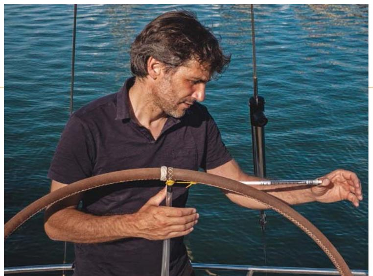
Una rueda que ofrece demasiada resistencia a la larga puede fatigar al patrón. Un perito con los instrumentos apropiados puede determinar, con medidas objetivas, si el par requerido para accionar la rueda es excesivo y definir así si es necesario revisar o ajustar algún elemento del sistema.
